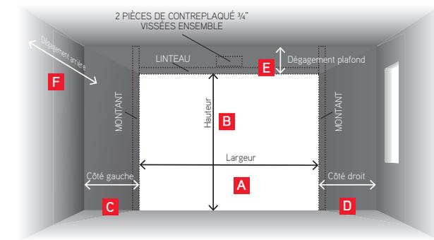
1) Mesurez (en pouces) l'ouverture où est située la porte en largeur **A** et en hauteur **B**. Ceci déterminera la grandeur de porte nécessaire. Ne jamais prendre les mesures par rapport à la porte existante.
